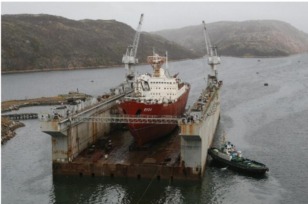
*Рис. 4. Спуск судна с помощью плавдока*
