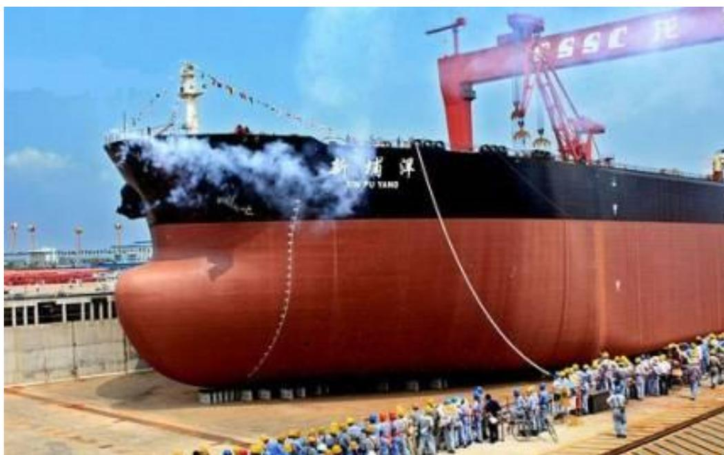
*Рис. 3. Спуск судна в заливном доке.*
