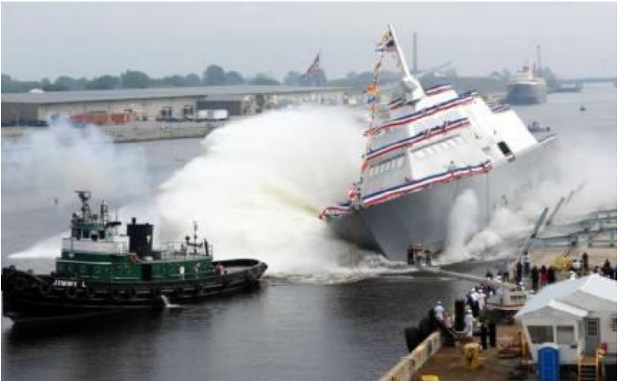
*Рис. 1. Поперечный спуск военного корабля*
