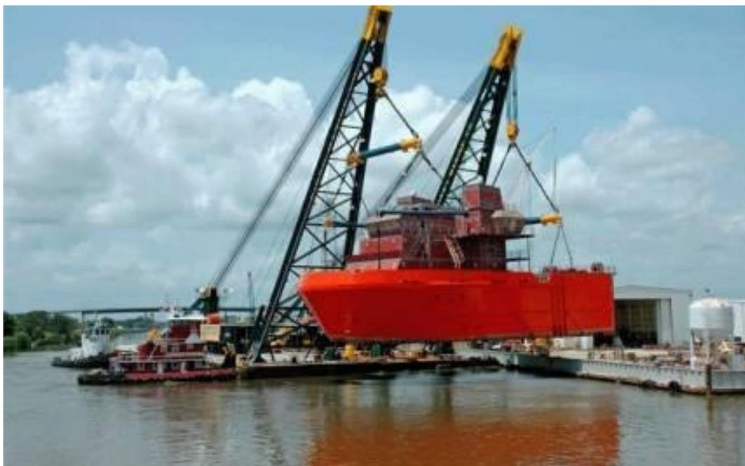
*Рис. 5. Спуск судна с помощью плавкрана*
